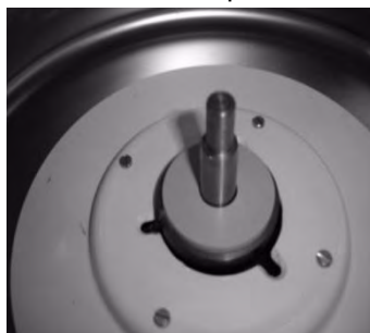
Eje del motor y cámara
